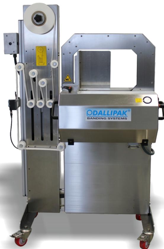
DB32 mit aufgebautem Druckwerk
